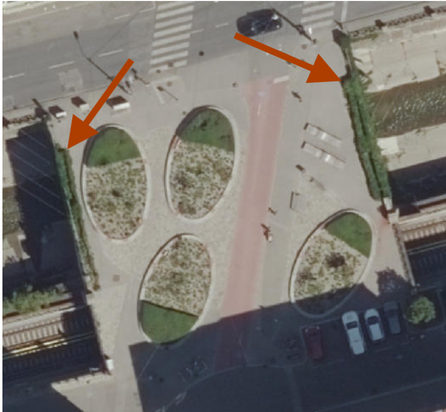
Abbildung 4: Luftbildaufnahme – zwei schmale, grünen Streifen, mit roten Pfeilen gekennzeichnet, sorgen für das üppige Wachstum der Brückenbegrünung.“
