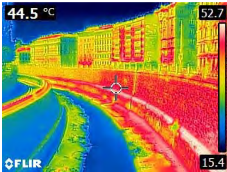
Abbildung 8: Die sonnenbeschiente Seite des Wienflusskanals: Der graue Kämpfer aus Beton hat zwischen 49,3 und 52,7 Grad (weißer Streifen im Wärmebild).
